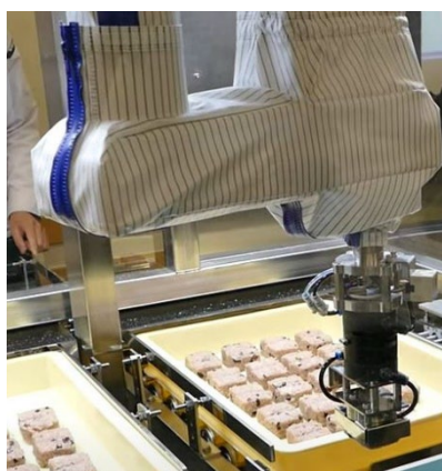
図 4-9 フードジャケットを装着した天吊り型ロボットとフードジャケット本体
