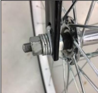
JIS D 9301(一般用自転車)で突起物は、「おねじが締付け相手部分(ナット面など)から、ねじの外径以上に長く突き出してはならない。」と規定されています。
